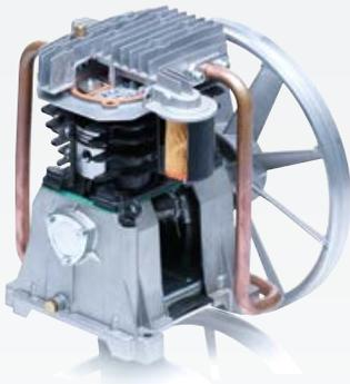
In den meisten Fällen besteht der Druckluftbedarf in Handwerksbetrieben und in der Industrie aus einer Grundlast und einer Spitzenlast. Hier können beide Verdichtersysteme ideal kombiniert werden. Der **Schraubenkompressor deckt die Grundlast, der Kolbenkompressor die Spitzenlast** ab.
